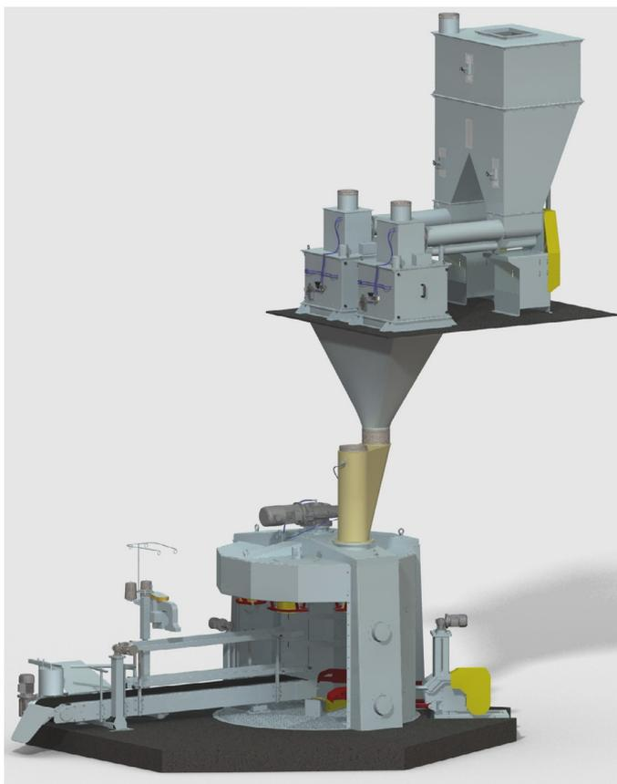
Карусельная установка дискретного действия для фасовки мешков предназначена для высокоскоростной карусельной фасовки сыпучих продуктов (мука, крупа, сахар, соль, комбикорма и др.) в мешки (полипропиленовые, бумажные, тканевые) с массой дозы 25-50 кг с последующей зашивкой и транспортировкой. Для мучнистых продуктов предусмотрено уплотнение продукта в мешке.
