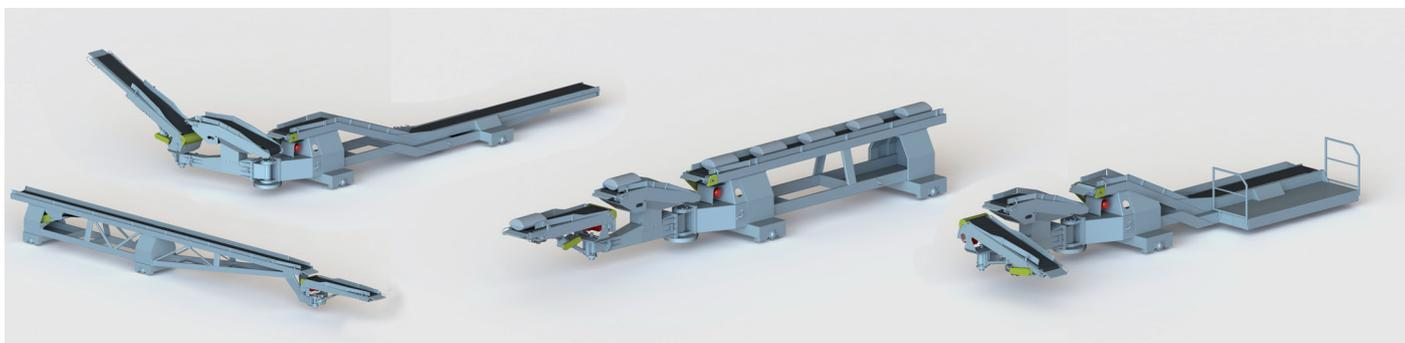
Комплексный механизм погрузки представляет собой систему шарнирно-сочлененных ленточных конвейеров, которые последовательно подают мешки к месту укладки.
