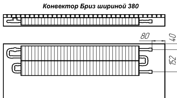
Расположение теплообменников в конвекторах Бриз шириной 380 (сечение)
