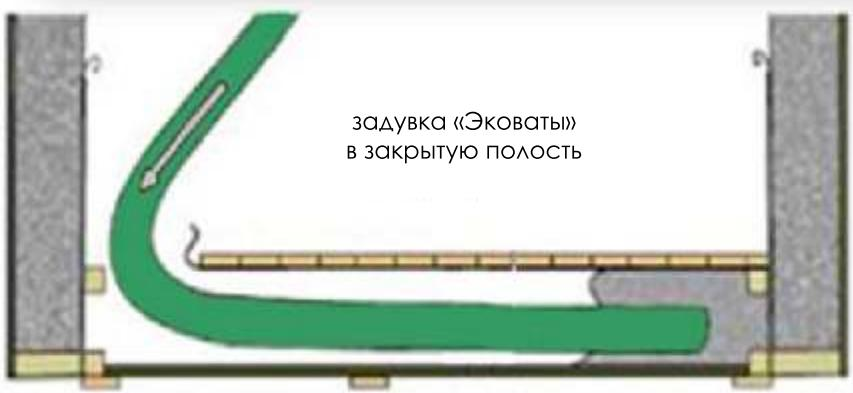
В межэтажных перекрытиях «Эковата» выступает в роли не только утеплителя, но и в роли звукоизоляции.
